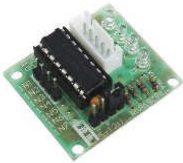
Figura 33: Driver para motor de passo ULN2003. (AUTOCORE)
