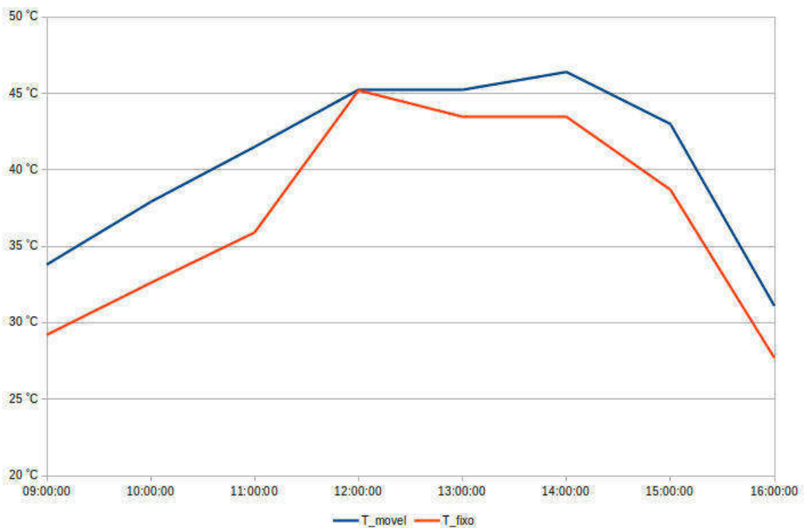
Figura 69: Comparativo entre as temperaturas dos painéis fixo e móvel ao longo do tempo
