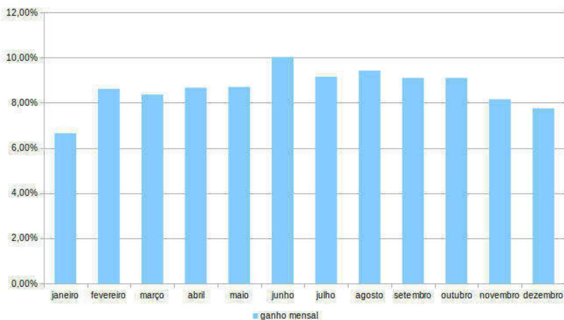
Figura 76: Distribuição do ganho obtido pela implantação do rastreador ao longo do ano
