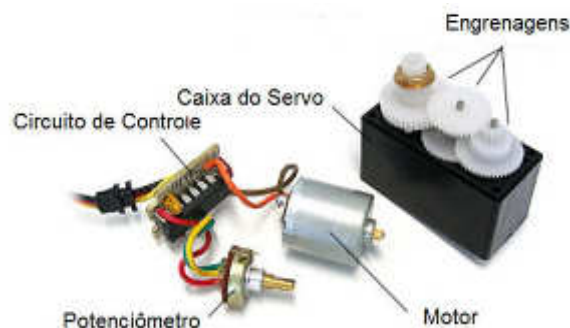
Figura 32: Componentes de um servo motor. (UNESP)
