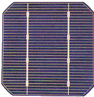
Figura 16: Silício monocristalino. (CRESESB, 2006)
