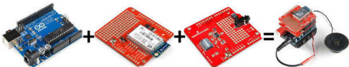
Figura 41: Modularidade e versatilidade da plataforma através dos Shields
