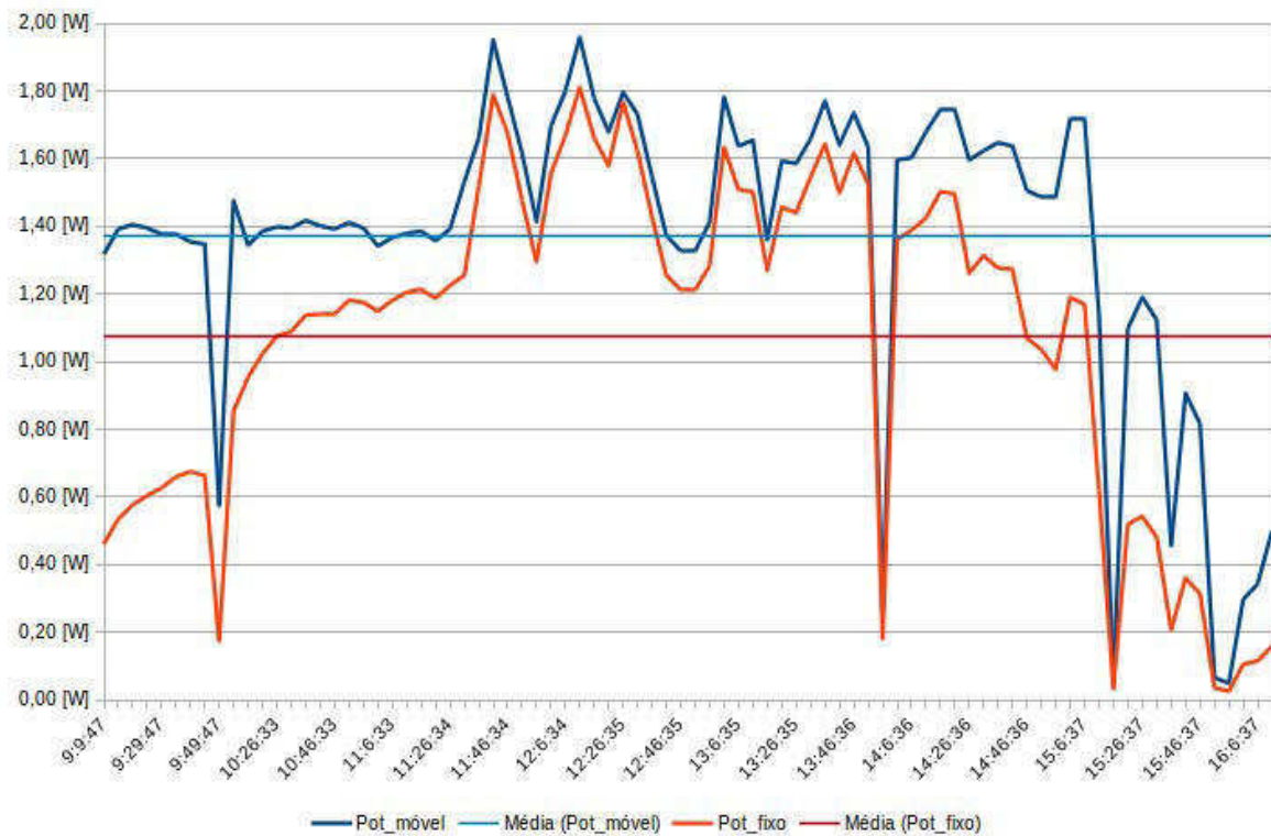
Figura 68: Comparativo entre a variação da potência entregue a cargas de mesmo valor pelos painéis fotovoltaicos, ao longo do dia.
